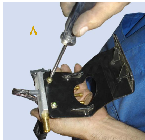
۸ - ریل سوخت را با باز نمودن ۲ عدد پیچ از روی پایه آن جدا نمائید. (۸)
