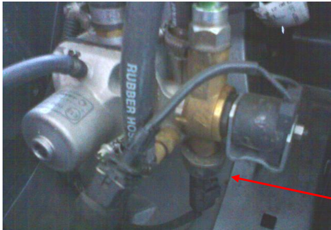
رگولاتور NG1 با سنسور فشار گاز پیزوالکتریک
