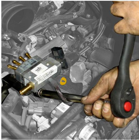
۷ - سپس مجموعه ریل سوخت را همراه با پایه از محل خودرو خارج نمائید. (۷)
